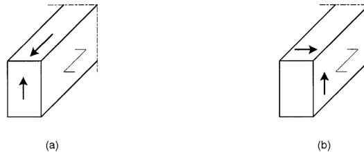
Figure 6.5 (a) Élément ayant une composante de contrainte en cisaillement parallèle au fil (b) Élément ayant deux composantes de contrainte perpendiculaires au fil (cisaillement roulant)
