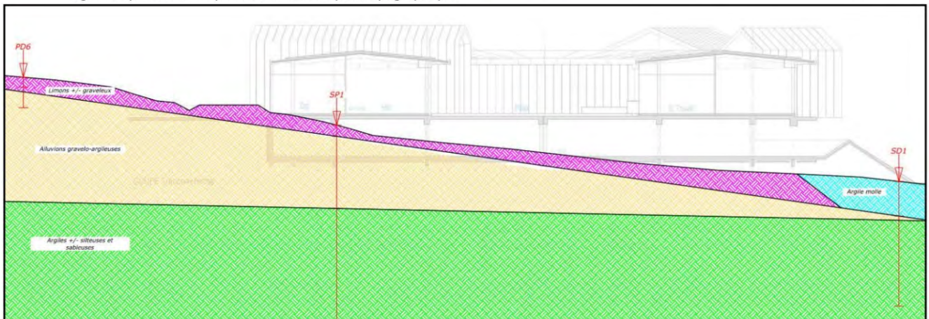
fig. 2 : Coupe géologique interprétative au droit du profil 1
