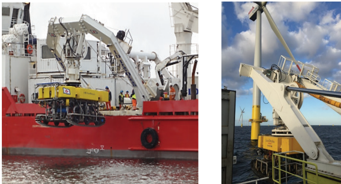
Figure 4 : ROV suspendu à la grue portique
