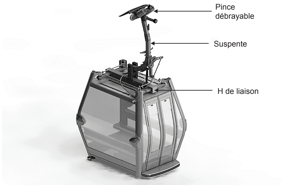
Figure 8 – Principaux éléments constitutifs de la structure porteuse
