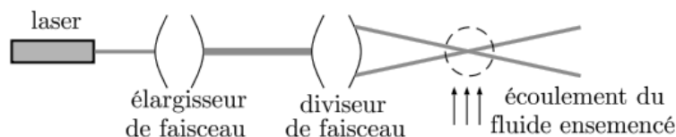
FIGURE 2 – Vue d'ensemble du dispositif
