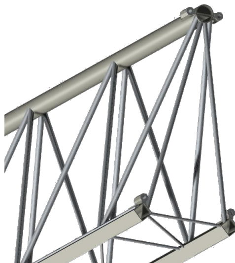
Figure 27 détails du treillis des bras
