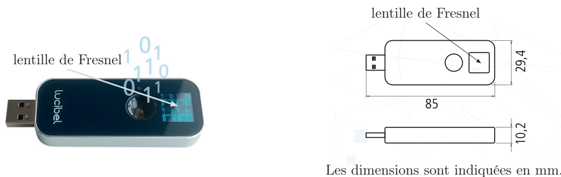
FIGURE 8 – Photo et dimensions d'un dongle USB Li-Fi (extrait d'un catalogue technique – mars 2022).
