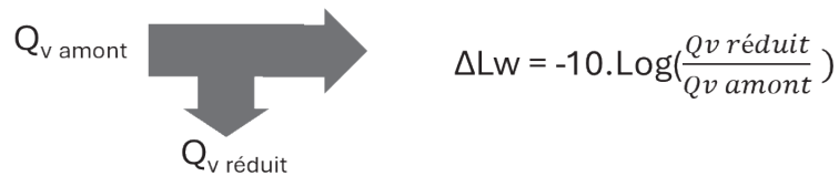
Valeur de l'atténuation \Delta Lw pour un embranchement en fonction des débits volumique Q (pour l'étude on la considèrera constante quel que soit la bande de fréquence)
