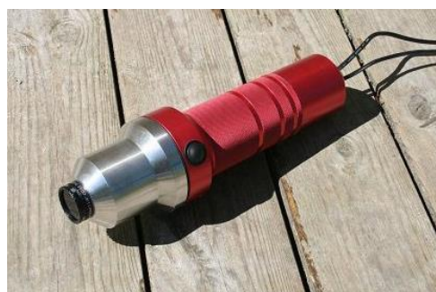
Figure 1 : photographie d'un modèle de système de navigation astrale (sextant électronique) de l'entreprise STARNAV (longueur environ 25 cm).
