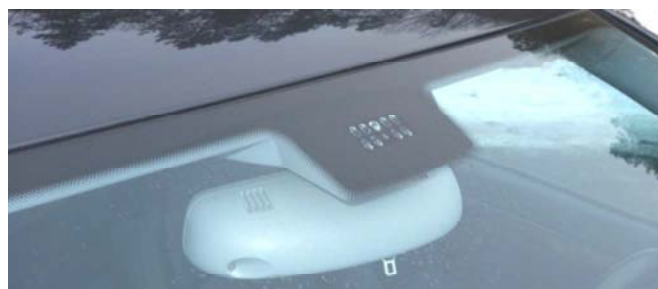
Figure 7 - Photographie d'un capteur sur le pare-brise d'un véhicule
