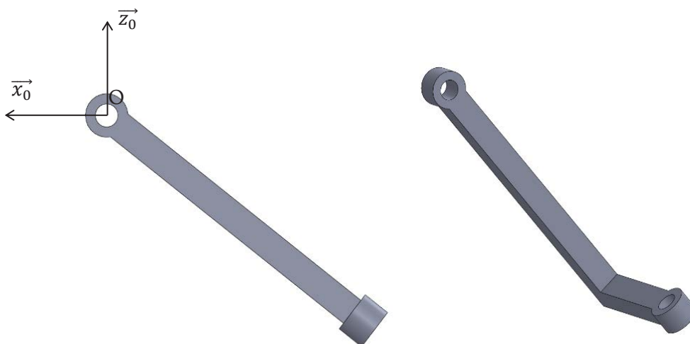
Figure 18 : modèle simplifié retenu pour l'étude de résistance des matériaux
