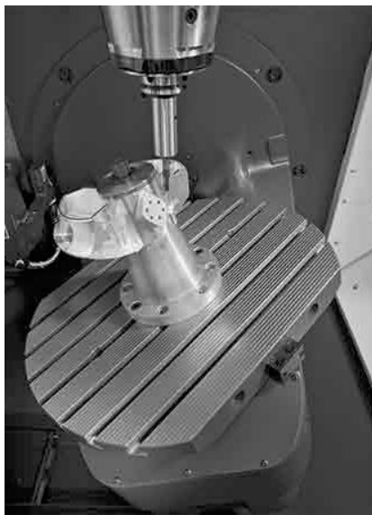
Figure 20 : machine-outil retenue et définition des cinq axes
