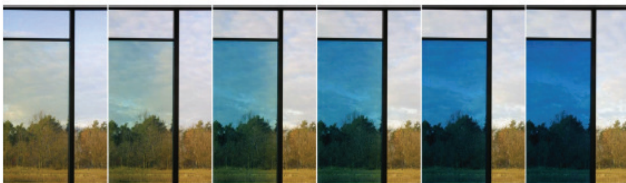
FIGURE 6 - Séquence de coloration d'une fenêtre électrochrome. Source : "Elektrochrome Verbundgläser Gesimat EC", Gesimat
