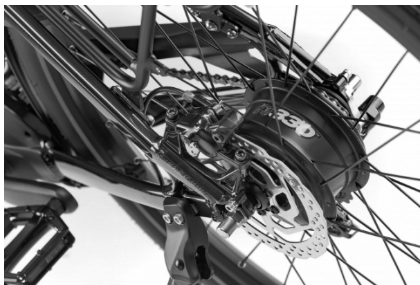
figure 7 : transmission arrière Nuvinci® 330
