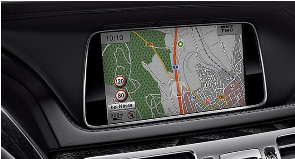
Figure 1 : Le système « Traffic Sign Assist » de Mercedes est intégré au véhicule
