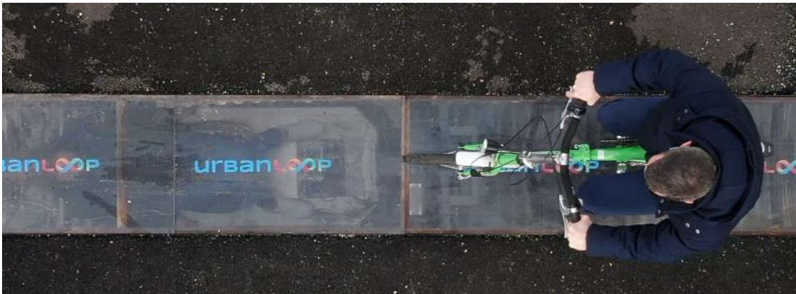
Figure 3 : exemple d'insertion urbaine sous une piste cyclable, le voyageur est visible par transparence à gauche
