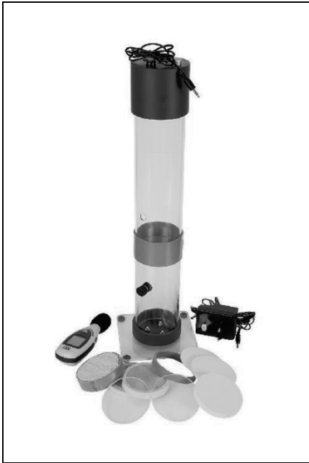
Figure 6 : descriptif du banc d'essais acoustique
