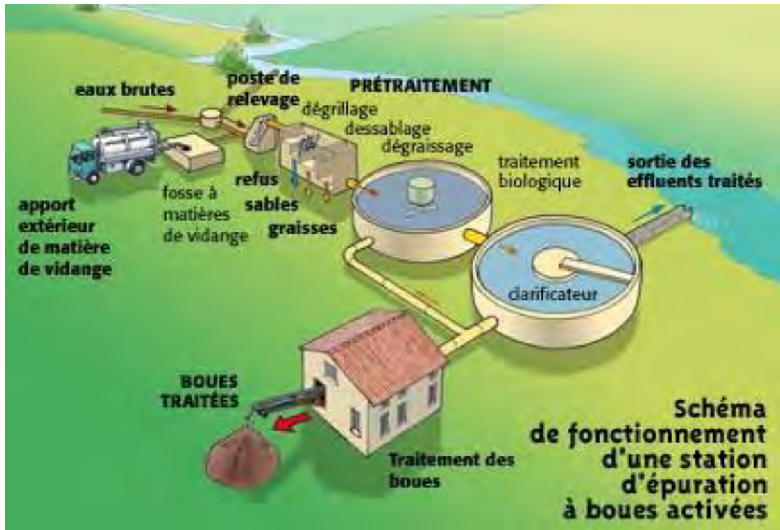
figure 2. Station d'épuration à boues activées (source ADEME)
