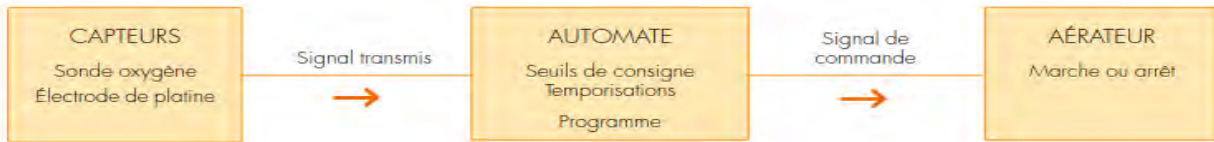
Figure III.3. – Chaîne d'automatisation par asservissement ou régulation
