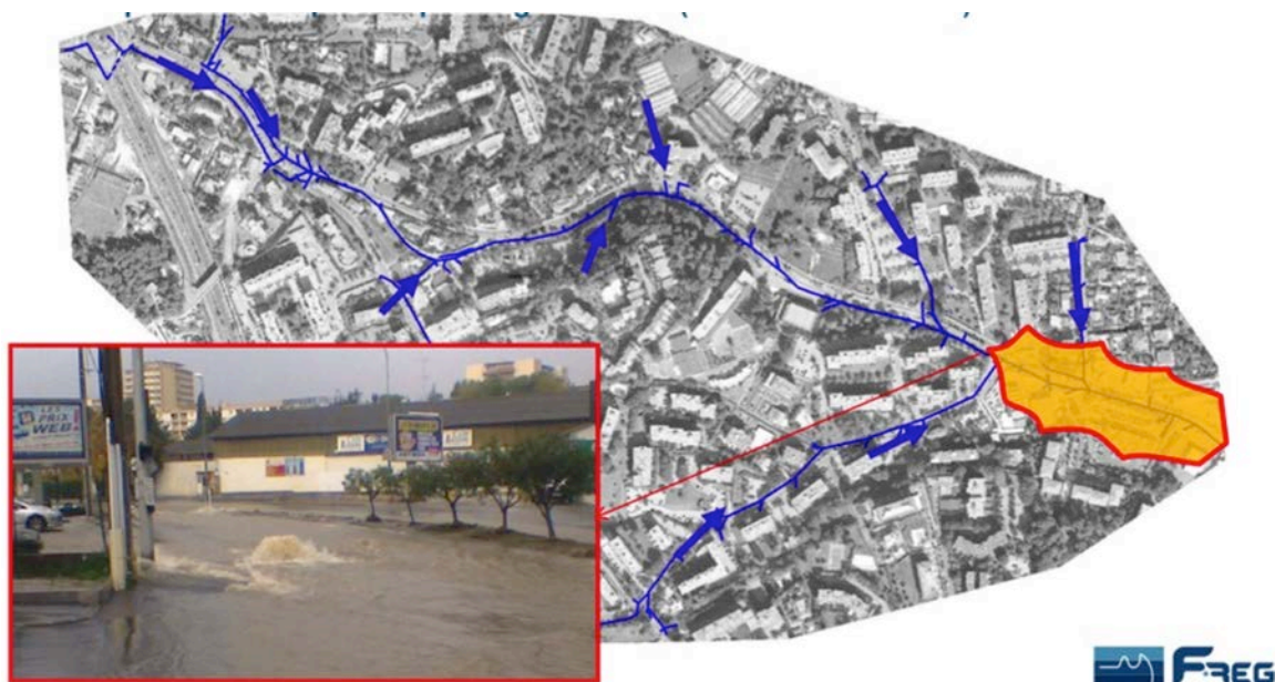
Figure 2 : illustration du principe d'inondation par déversement au point aval des réseaux d'eaux pluviales de la route de Grasse à Antibes. L'eau de pluie, collectée au niveau des différents collecteurs (flèches) n'est pas retenue et s'écoule vers le point le plus bas, causant la saturation du réseau et jaillissant des collecteurs aval.
